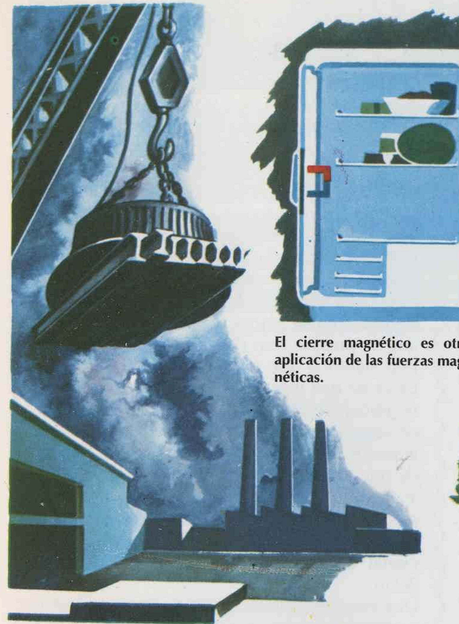
Existen grúas para elevar piezas de hierro por la acción magnética de un electroimán.
