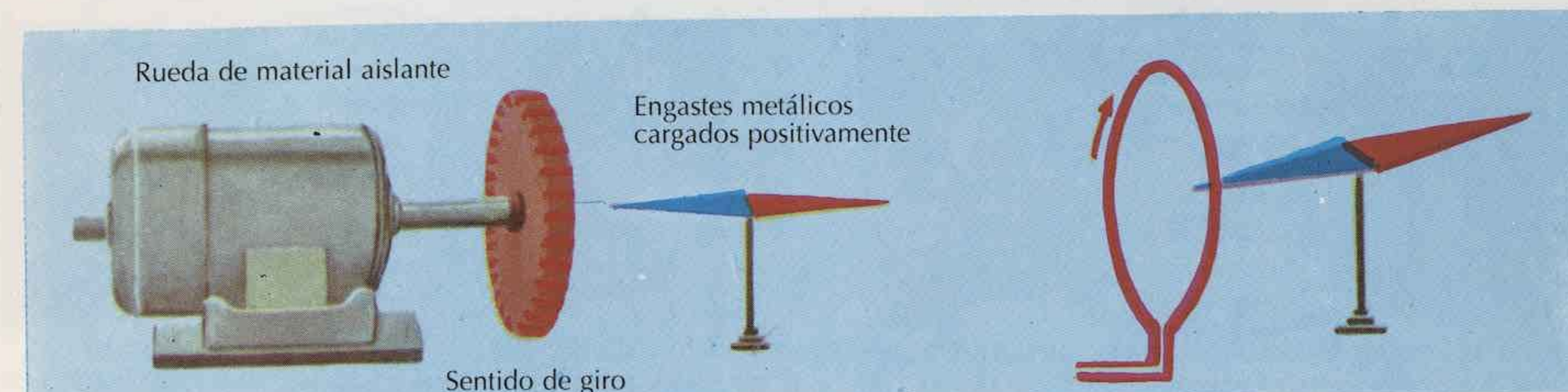
Al girar, la rueda de Rowland crea un campo magnético (figura de la izquierda) análogo al creado por una espiral circular (figura de la derecha).
