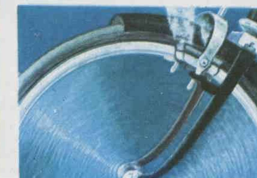
La disminución de energía cinética es igual al calor desprendido en los frenos.
