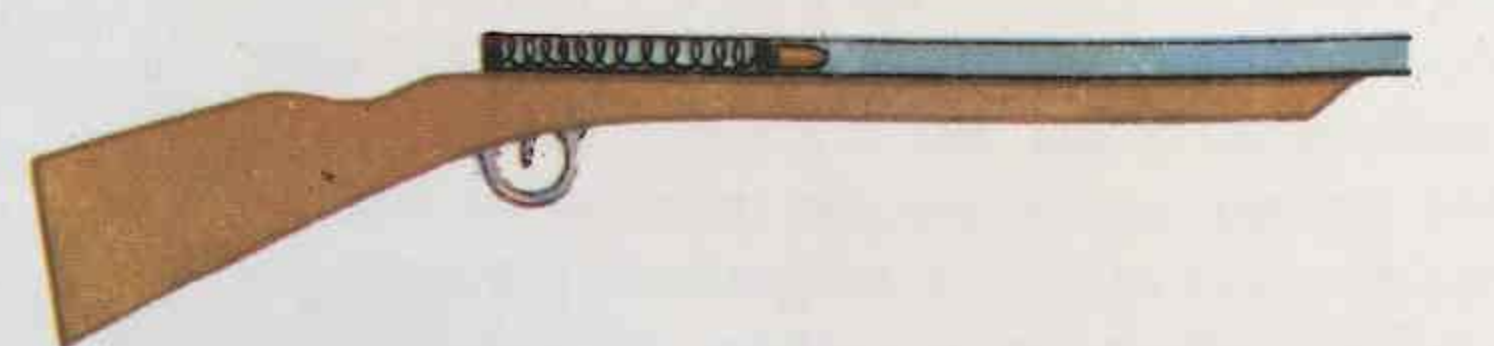
El resorte comprimido puede realizar un trabajo, si se suelta; posee energía potencial.
